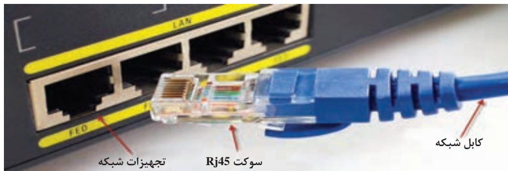
شکل ۶- اتصال سوکت RJ45 به تجهیزات شبکه
