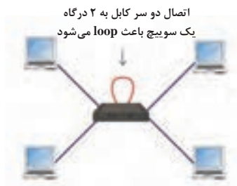
شکل ۵۹- وجود loop در سوییچ
