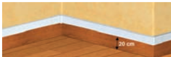
شکل ۵۲ - فاصله داکت یا ترانک از کف
