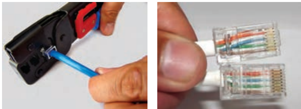
شکل ۲۹- پرس کردن سوکت RJ45
