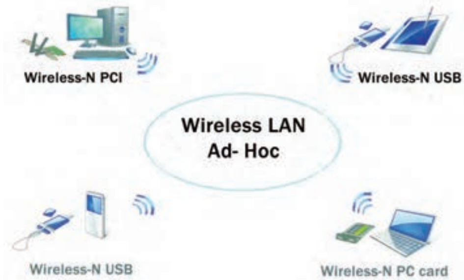
شکل ۳- پیکربندی شبکه بی سیم با Ad Hoc
