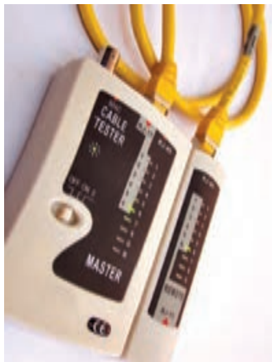
شکل ۲۰- تست کابل شبکه
