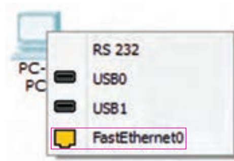
شکل ۶- انتخاب درگاه برای اتصال کابل
